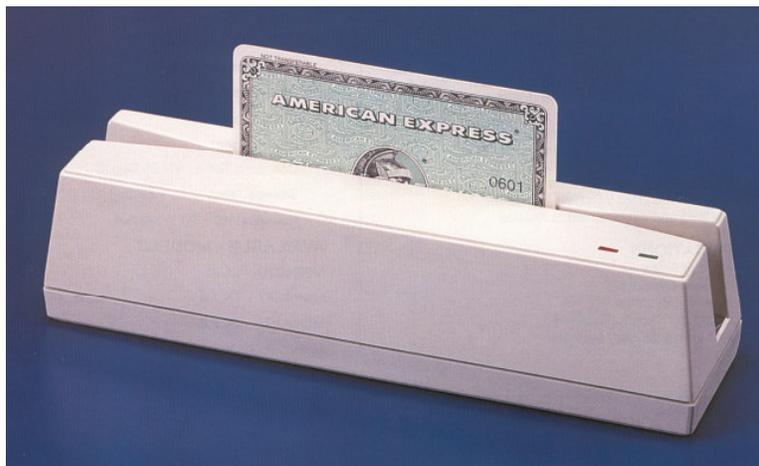
L'MSR400U è un lettore di badges in emulazione di tastiera via USB. Può essere collegato a PC o terminali dotati di porta USB.
