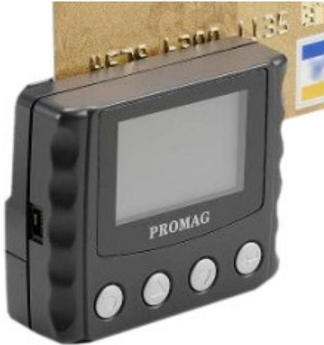
MSR120 è un mini-lettore di badges magnetici portatile, dotato di display LCD e di orologio interno, alimentato a batterie.
